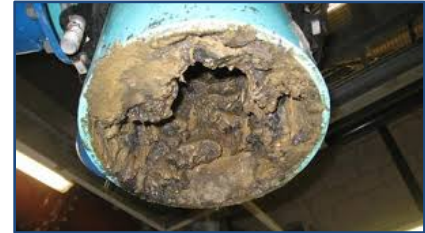
Línea de alcantarillado obstruido causada por FOG
